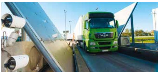
Un scanner à ondes passives et un système vidéo permettent la détection d'éventuels passagers clandestins à bord des camions
